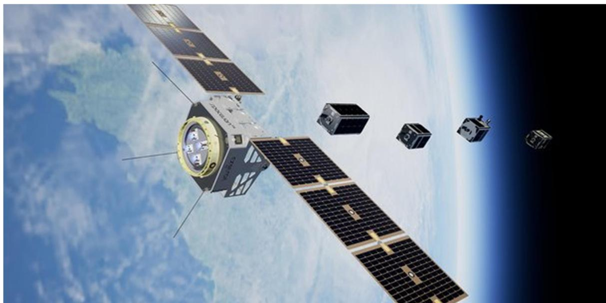
Ensuite, le **SpaceVan** va à sa deuxième position pour aller larguer son deuxième satellite et ainsi de suite; donc c'est un véhicule, c'est un satellite convoyeur qui aura la capacité d'amener à plusieurs endroits dans l'espace plusieurs centaines de kilos de petits satellites.
